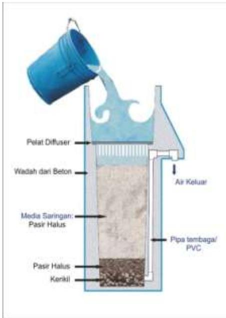
**Biosand adalah proses penyaringan secara fisik, yaitu menyaring air melalui media pasir dan lapisan biologis**
