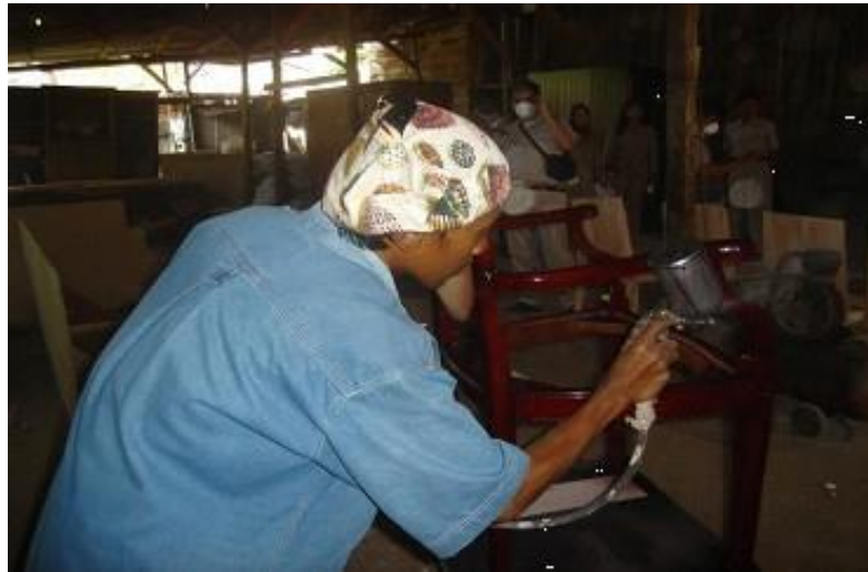
Gambar Perajin Kayu Menggunakan Bahan Kimia untuk Melapisi Kayu (Sumber: Lestari et al., 2007)
